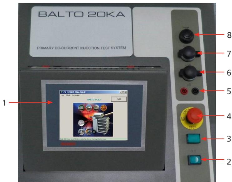
Fig.17 : Panneau de commande du BALTO Modular
