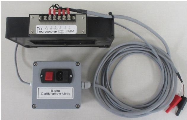
**Fig.49 :** Capteur pour l'étalonnage
