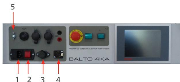
Fig.15 : Alimentation, fusibles et connecteur de charge
