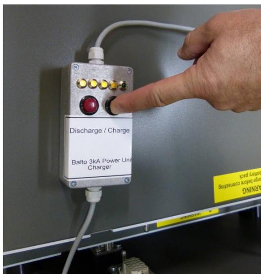
**Fig.28 :** Charge d'un générateur de courant CC
