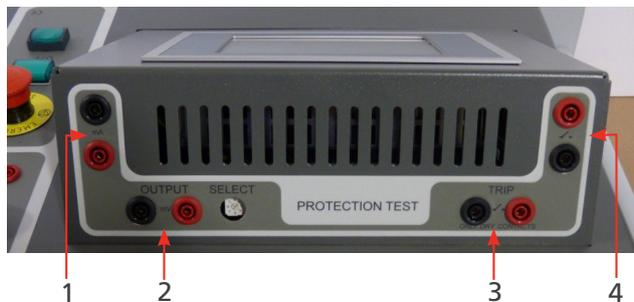
Fig.8 : Unité de commande : Interface pour relais de protection CC
