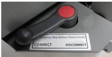
Fig.14 : Dispositif d'arrêt d'urgence
