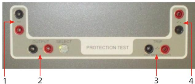
**Fig.16 :** Interface pour relais de protection CC
