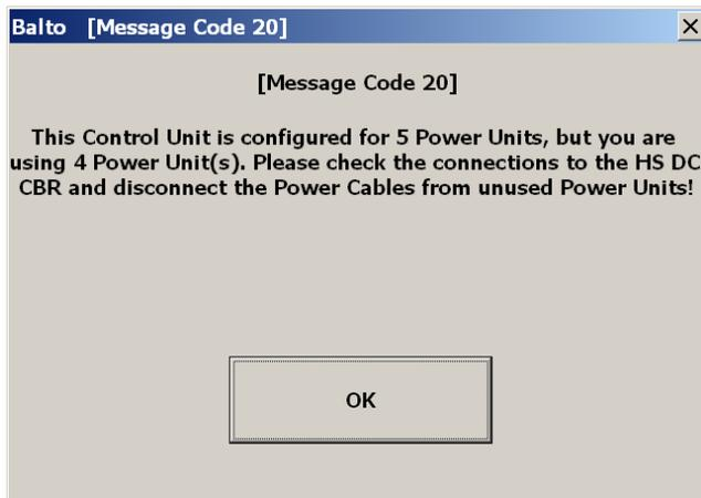
**REMARQUE :** Il n'est pas toujours nécessaire de brancher toutes les unités de puissance. Le nombre d'unités de puissance dépend de l'injection de courant requise pour exécuter le test.
