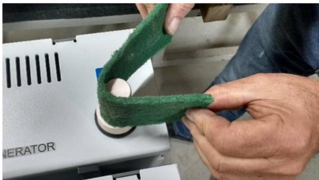
Fig.52 : *Nettoyage des connecteurs électriques.*
