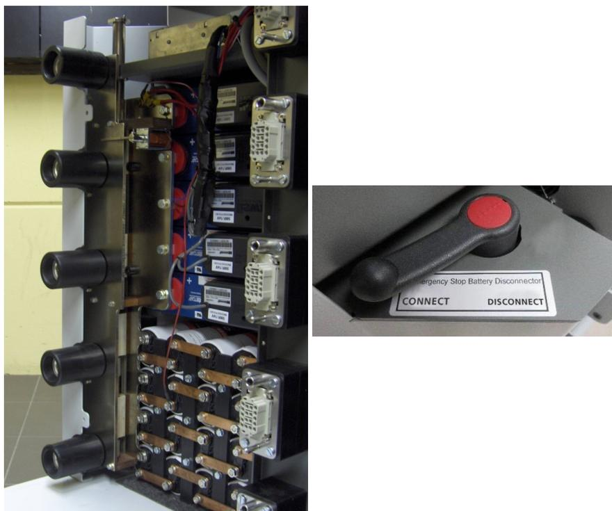
Fig.4 : Chariot : Dispositif d'arrêt d'urgence
