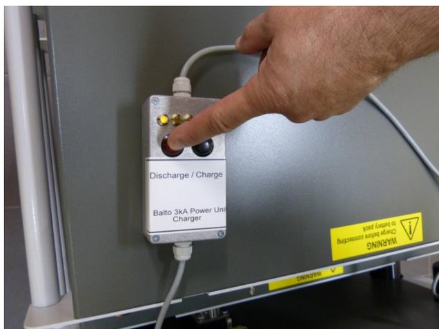
Fig.40 : Décharge d'un générateur de courant CC
