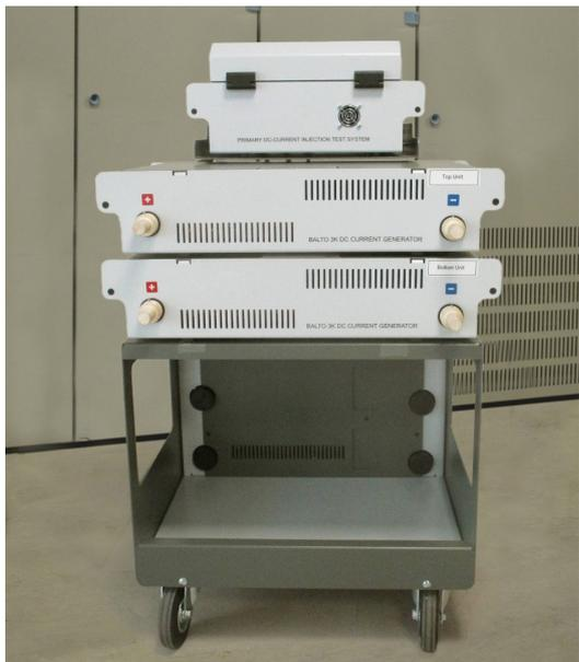
**Fig.33 :** Système *BALTO Modular* avec seulement deux logements
